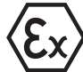
Fig.1 – Specific marking for protection against explosions – Directive 94/9/EC Abbildung 1 – Spezifische Kennzeichnung für Explosionsschutz - Richtlinie 94/9/EC Figura 1 – Marque spécifique pour la protection contre les explosions - Directive 94/9/EC
